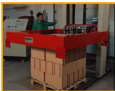
Mașină automata orizontală pentru paletizare cu banda PP și PET
